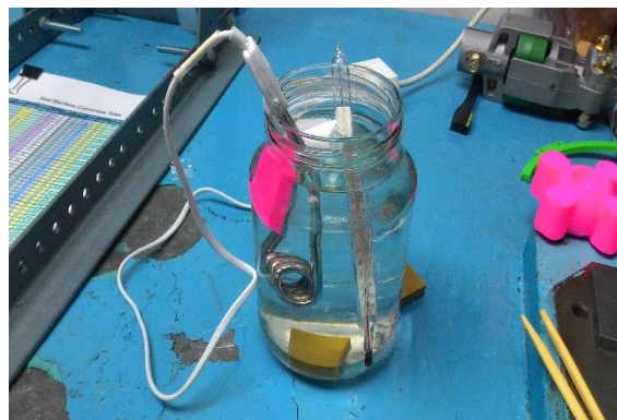
Рисунок 2 – Оборудование для определения твердости различных видов пластика, в зависимости от температуры
