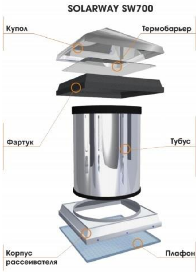
Рисунок 1. Схема полого трубчатого световода Таким образом, с целью экономии электрической энергии рекомендуется передавать световой поток в помещения по системе световодов.
