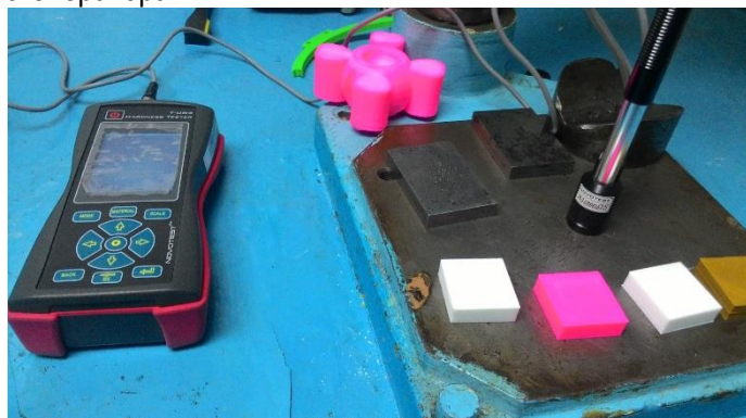
Рисунок 2 – Оборудование для определения твердости различных видов пластика, в зависимости от температуры
