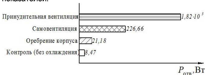
Рисунок 1. Результаты расчетов отводимой мощности различными системами охлаждения
