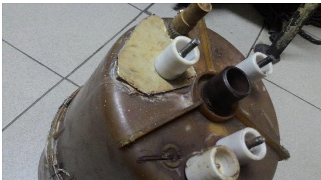
Рисунок 1 – Корпус, непригодного к эксплуатации электродного парогенератора
